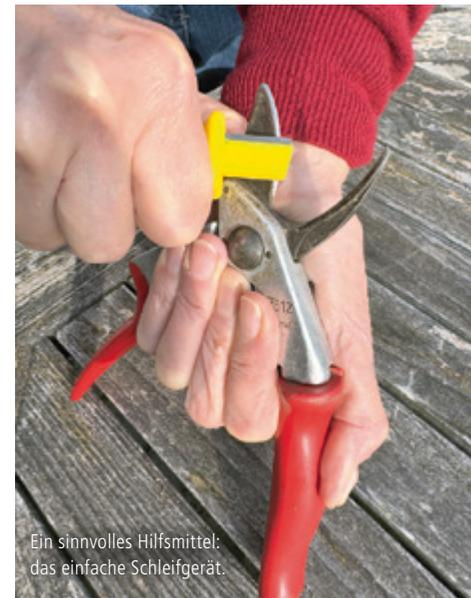
Ein sinnvolles Hilfsmittel: das einfache Schleifgerät.
